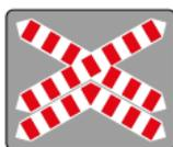
**Gla** : Signalisation de position des passages à niveaux à plusieurs voies sans barrière
